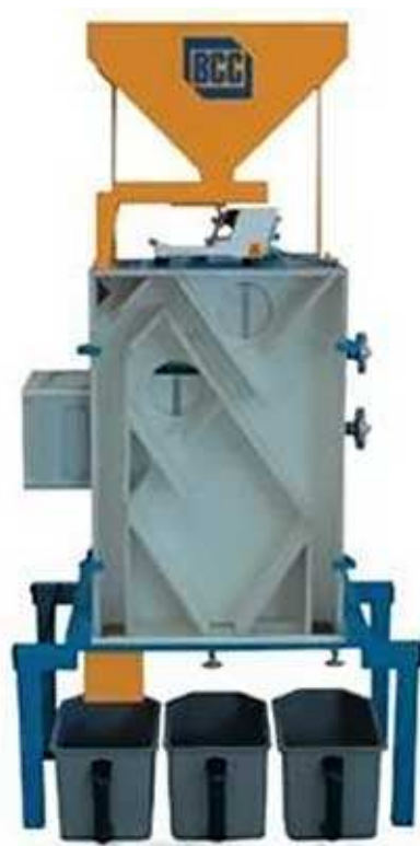
Рис.1.5. Гравітаційний сепаратор насіння з сортувальними камерами
