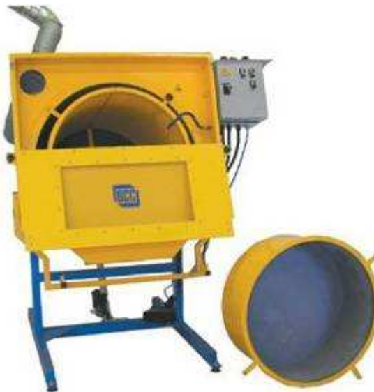
Рис.. 1.3. Установка для вылучення та обезкрилення насіння
