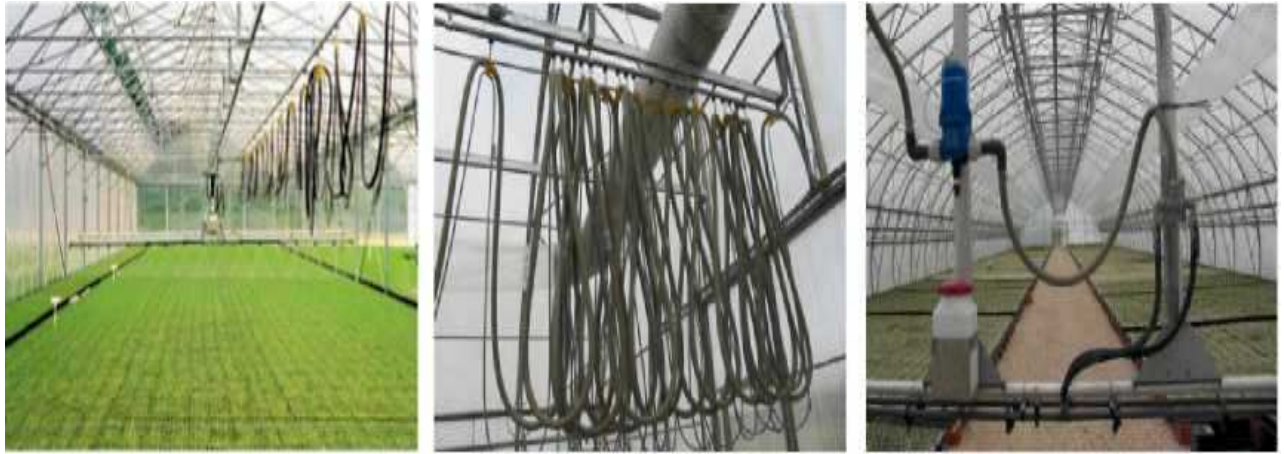
Рис. 2.9. Окремі вузли зрошувальної установки для теплиць
