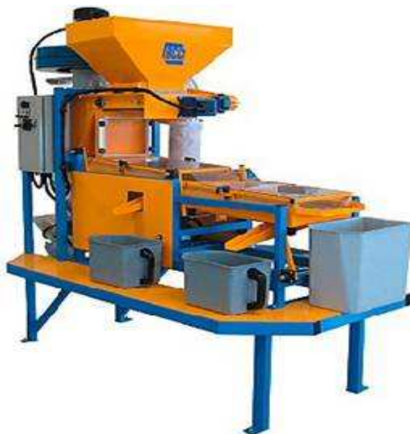
Рис.1.4. Загальний вигляд установки “Міні” для очищення і сортування насіння
