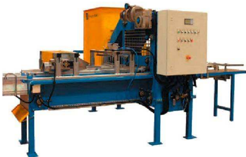
Рис. 2.5. Установка для наповнення ємностей і касет субстратом
