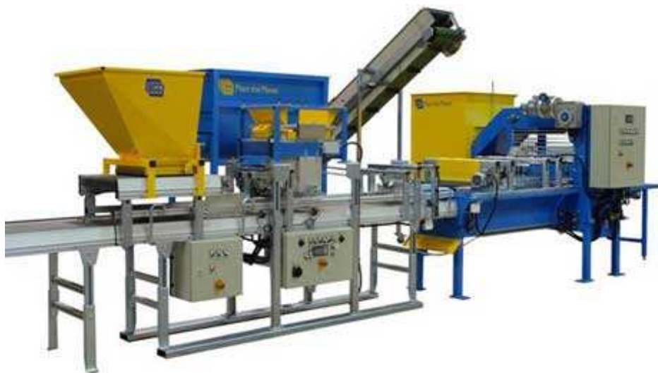
Рис. 2.6. Загальний вигляд лінії для заповнення касет субстратом і висіву насіння
